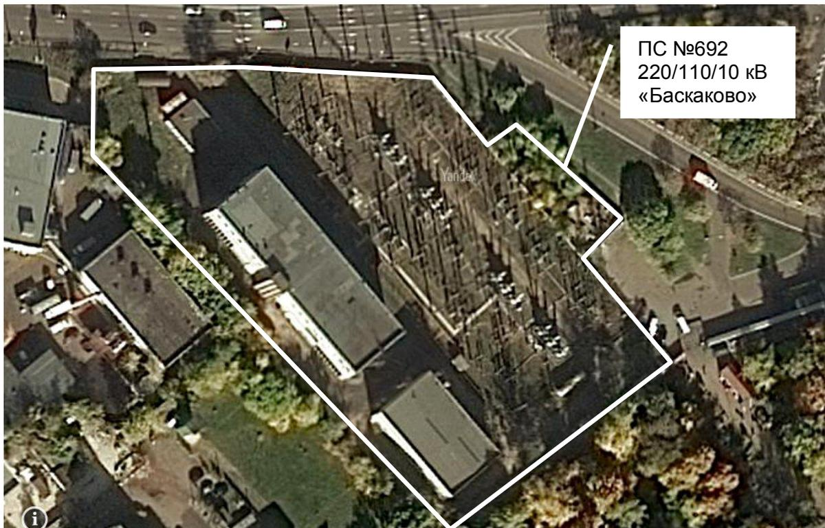
Подстанция располагается в зоне жилой застройки районов Вешняки и Новокосино г. Москвы. Подстанция оснащена двумя автотрансформаторами напряжением 220/110/10 кВ мощностью 200 МВА каждый. Год принятия в эксплуатацию: АТ-1 – 1983 г.; АТ-2 – 1986 г.
