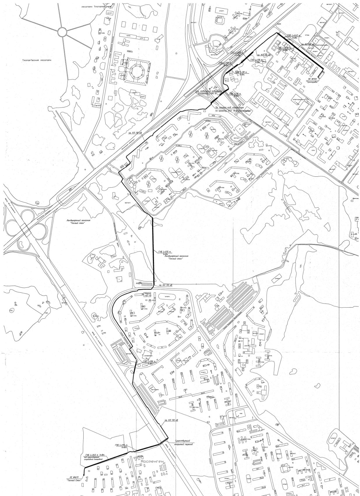
Рисунок 3.1. План трассы КП 110 кВ «Тропарево – Теплый Стан №1, № 2».
