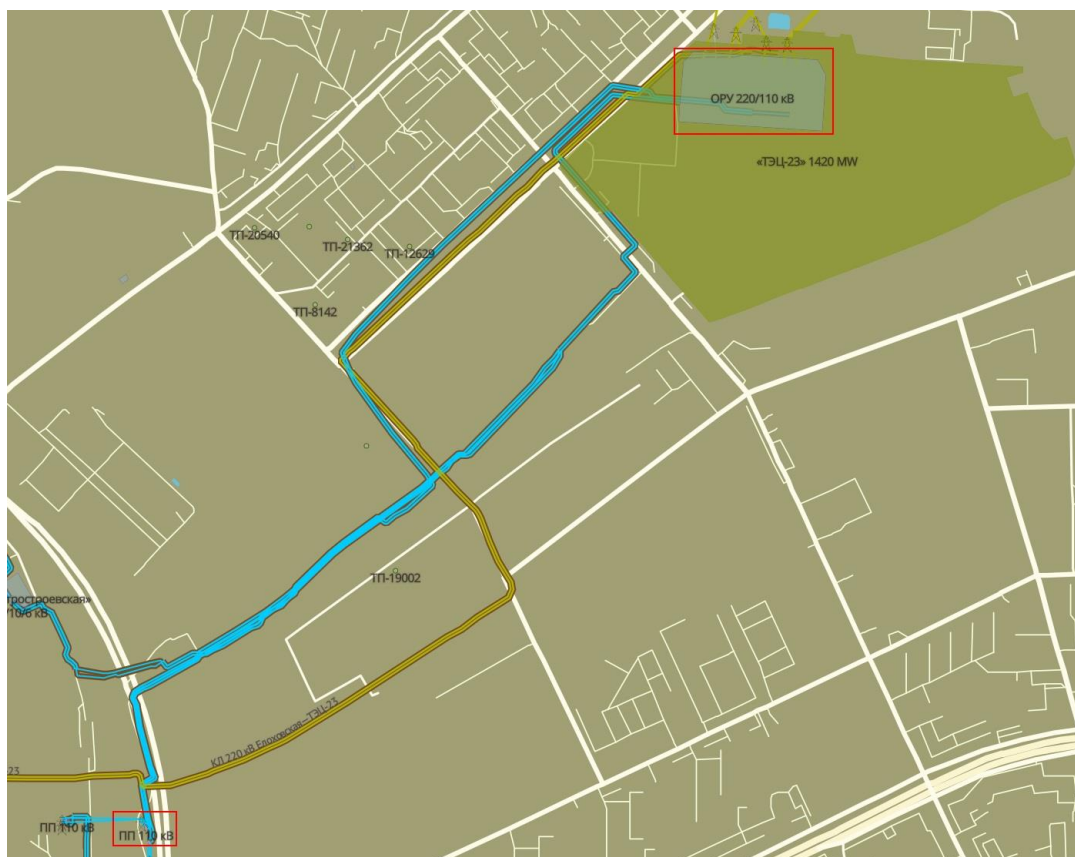
Рисунок 3. Ситуационный план КВЛ 110 кВ ТЭЦ-23 - Электрозаводская I, II цепь.
