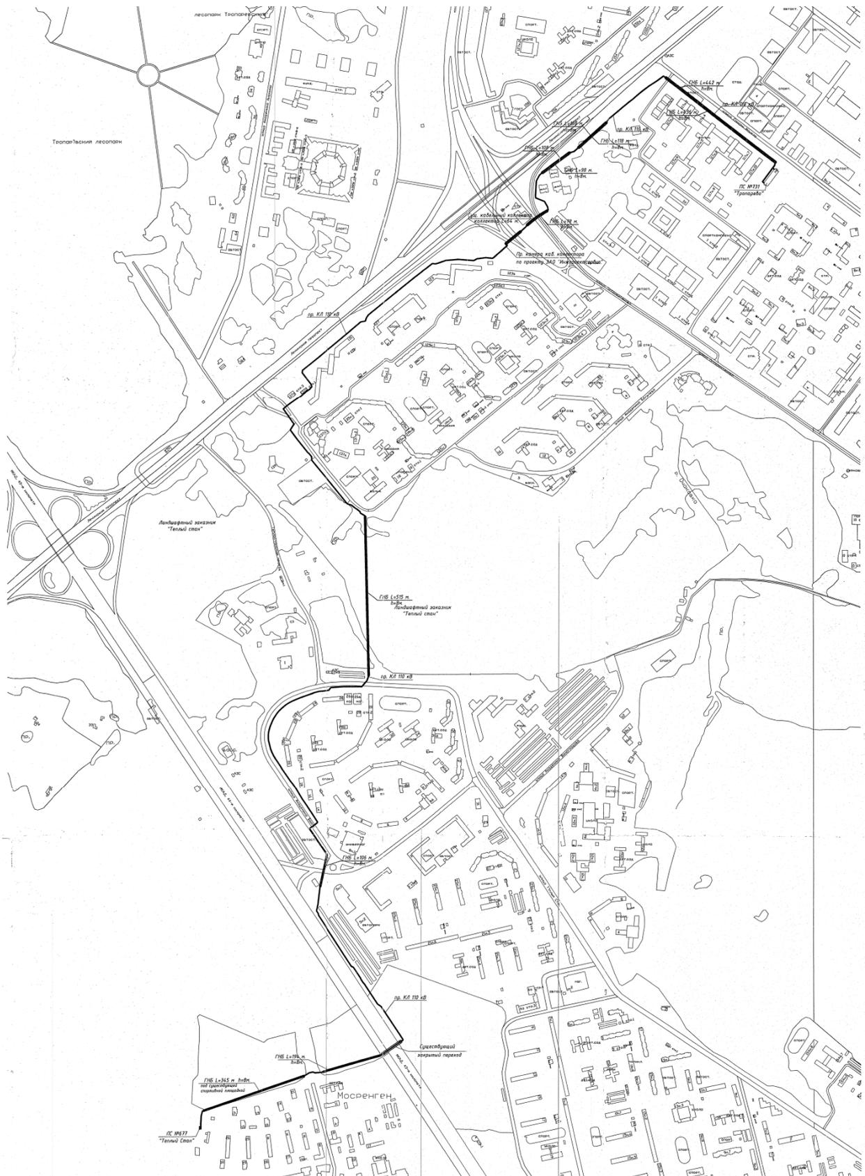
Рисунок 3.1. План трассы КЛ 110 кВ «Тропарево – Теплый Стан №1, № 2».
