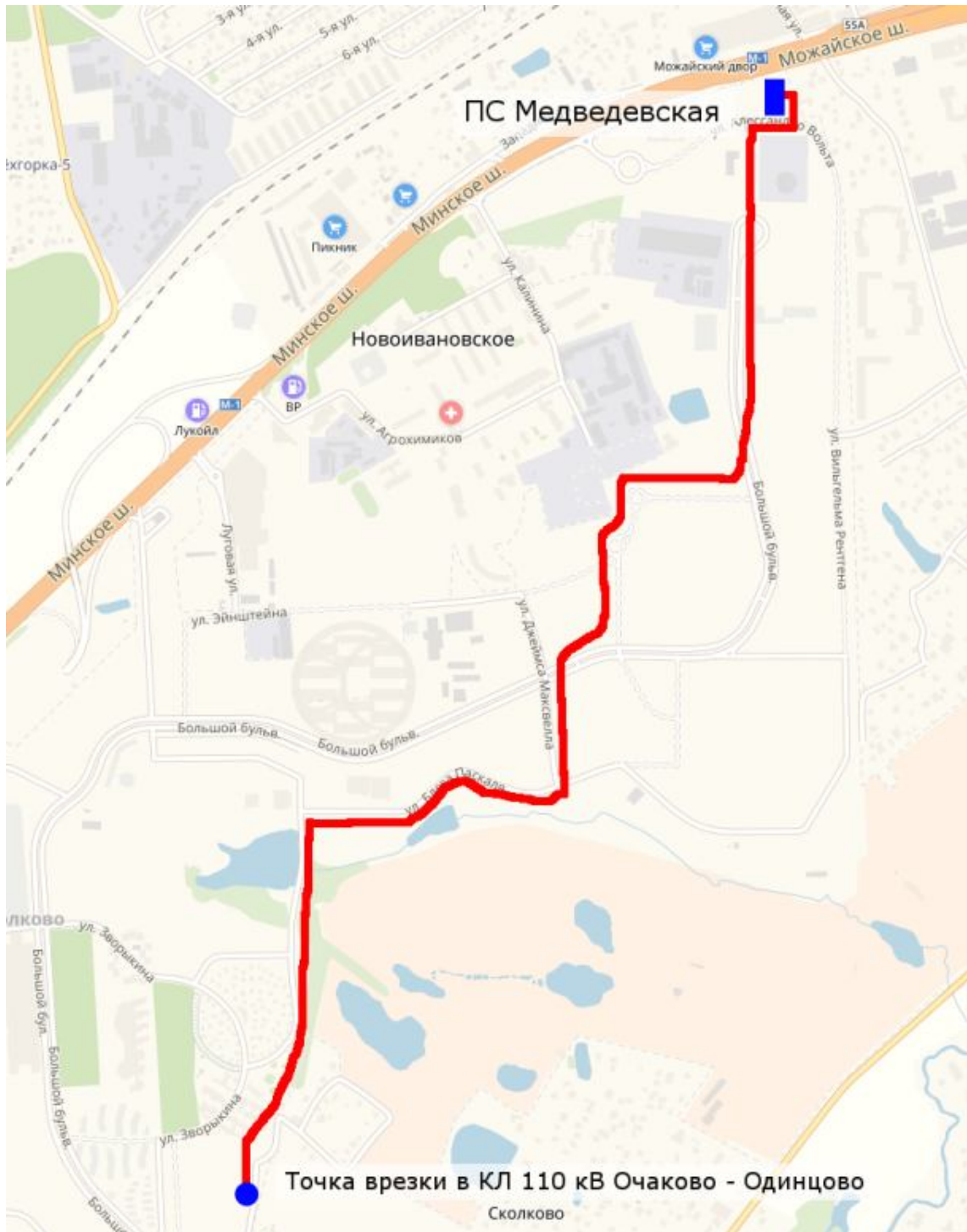
Рисунок 2. Трасса заходов 110 кВ на ПС Медведевская.
