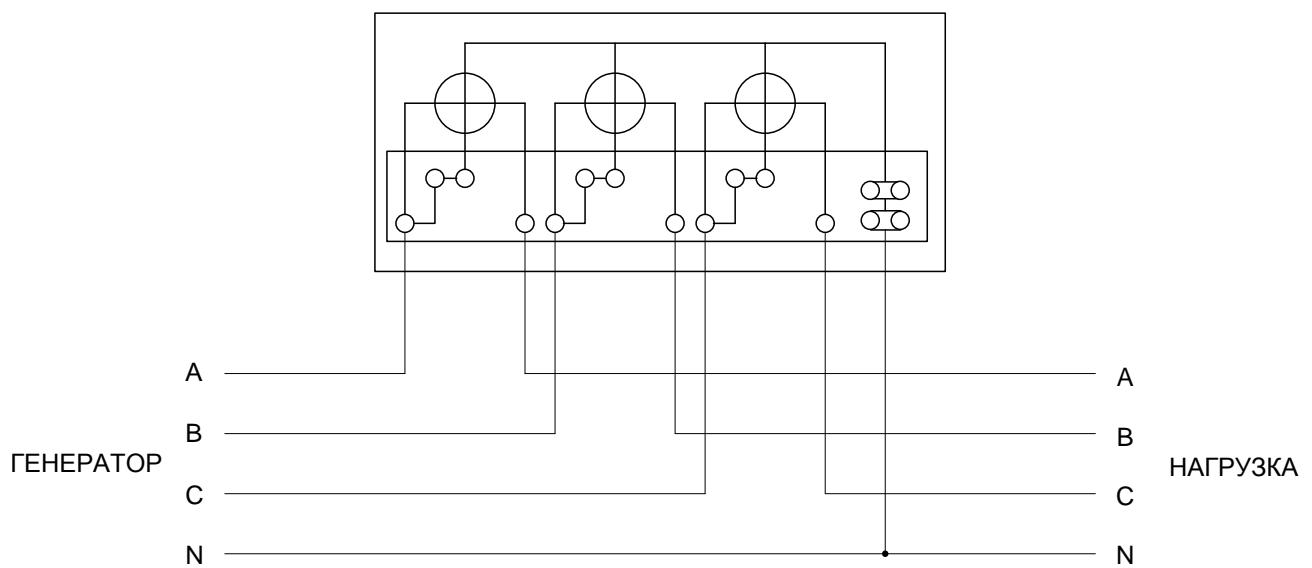
Пример схемы подключения трехфазного электросчетчика
